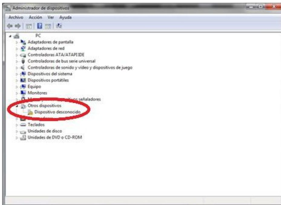
Presionamos botón derecho sobre el dispositivo desconocido y seguidamente en “actualizar software de controlador...”
